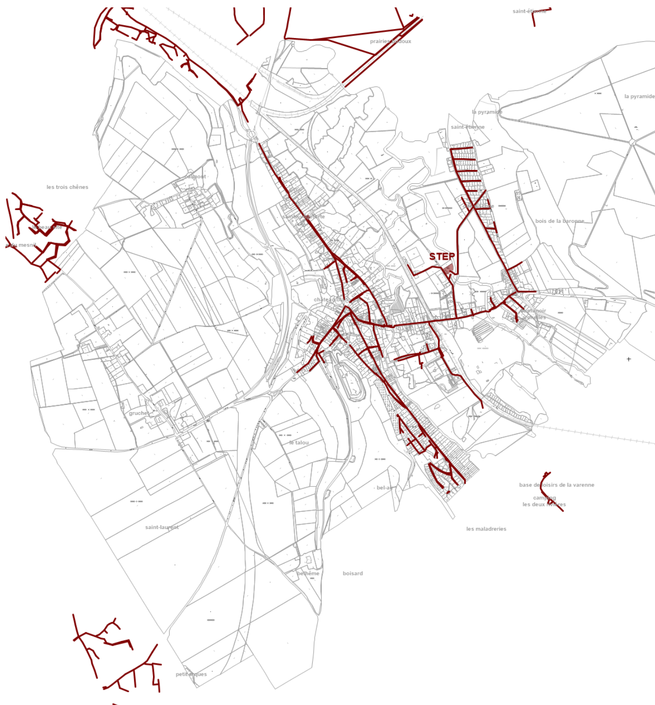
Figure 130 : Réseau d'assainissement (source : Dieppe Maritime)
